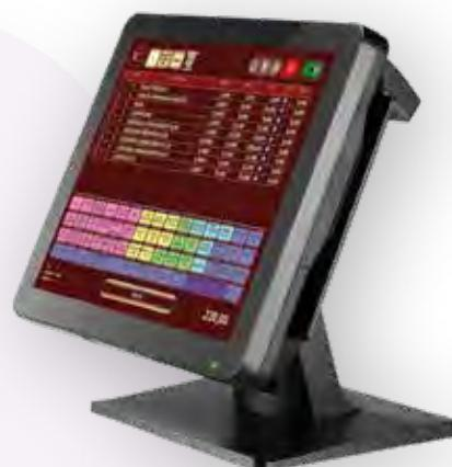
Optimalan POS terminal u pogledu cjenovne prihvatljivosti i kvalitetnih performansi. Fleksibilan modularan dizajn s mogućnošću priključka dodatnog displaya. Prednji panel otporan na prašinu i tekućine (IP65). Uređaj je pogodan za montažu na zid (VESA) - široki kut nagiba.
